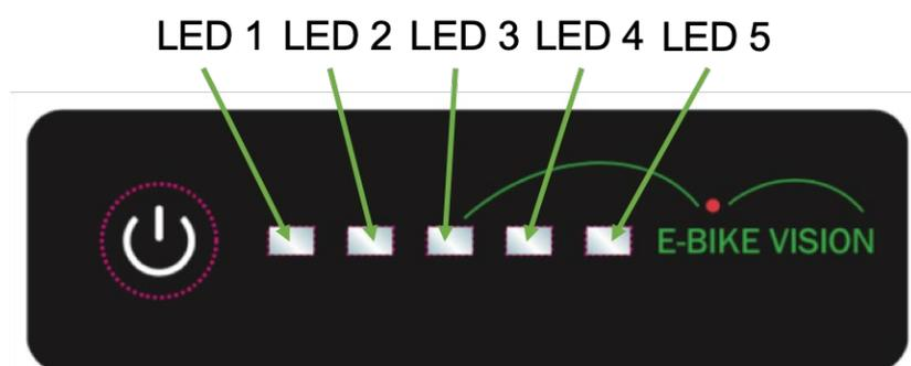
**Durante il processo di carica la capacità viene visualizzata dall'accensione e dal lampeggio dei LED sulla batteria come di seguito indicato:**
